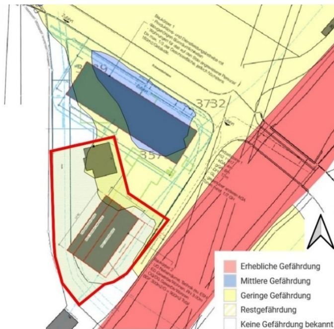
Abbildung 2: Ausschnitt aus der Gefahrenkarte Frutigen (Daten gemäss Geoportal des Kantons Bern [3]). Der Bereich der neuen Mischzone ist rot markiert und liegt in der gelben Gefahrenzone (unmassstäbliche Darstellung).
